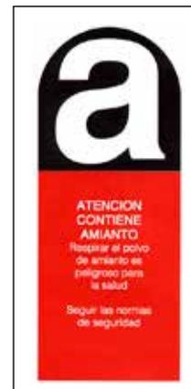
Figura 8. Etiquetado de los productos que contengan amianto.
